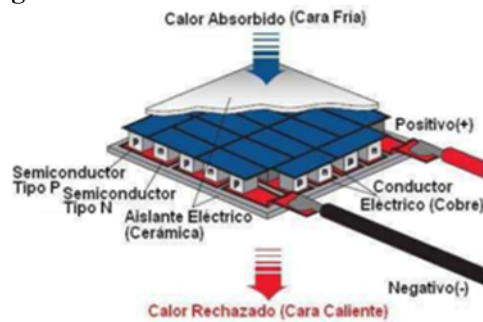
Figura 5. Estructura interna de una celda de Peltier
