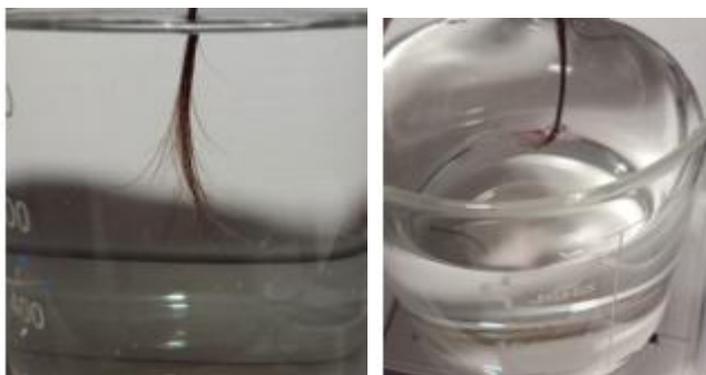
Imagen 8. Inmersión para la prueba de porosidad
