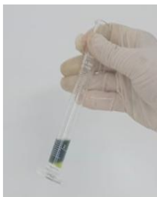
Imagen 1. Determinación cualitativa de polifenoles en romero (tubo de ensayo con solución azul) y Quinua (probeta con muestra verde)
