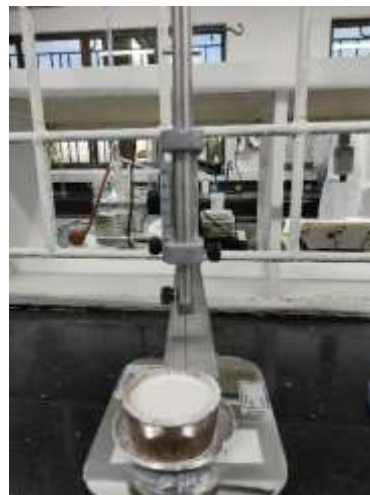
Fig. 15. Prueba de fraguado para el sulfato de calcio hemihidratado.
