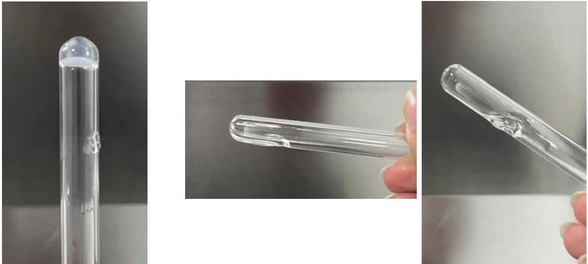
Fig. 1 Resultado de la prueba de interferencias del método Gel-Clot. A la izquierda: gelificación firme correspondiente al control positivo (0.50–0.25 UE/mL). Al centro y derecha: tubos correspondientes a concentraciones inferiores (0.125 y 0.0625 UE/mL) y al control negativo, donde no se observa formación de gel, indicando que el producto no interfiere con la reacción del lisado LAL.
