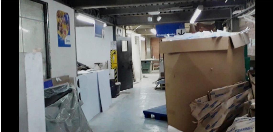
Imagen 13: Obstrucción de las rutas de evacuación.
