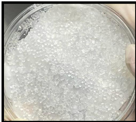
Figura 4. Microcápsulas recubiertas con carboximetilcelulosa (CMC).
