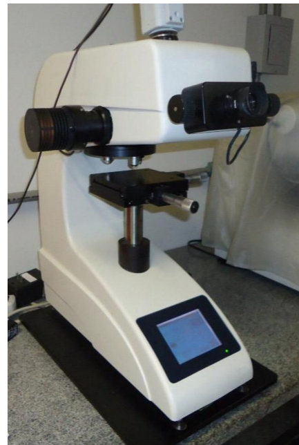
Figura 3. Microdurómetro SHIMADZU - HMV ® . Fuente: archivo de colección propia.
