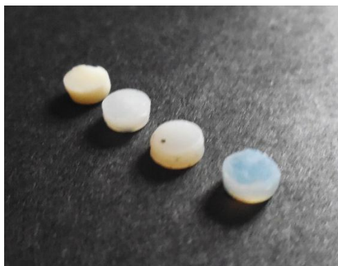
Figura 2. Cuerpos de prueba de los cuatro tipos de resina. Fuente: archivo de colección propia.
