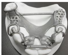
Ilustración 12. Producción de estructura metálica removible de la máquina ProX DMP200 dental.
