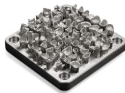
Ilustración 11. Producción de cofias y pñnticos de la máquina ProX DMP200 dental.
