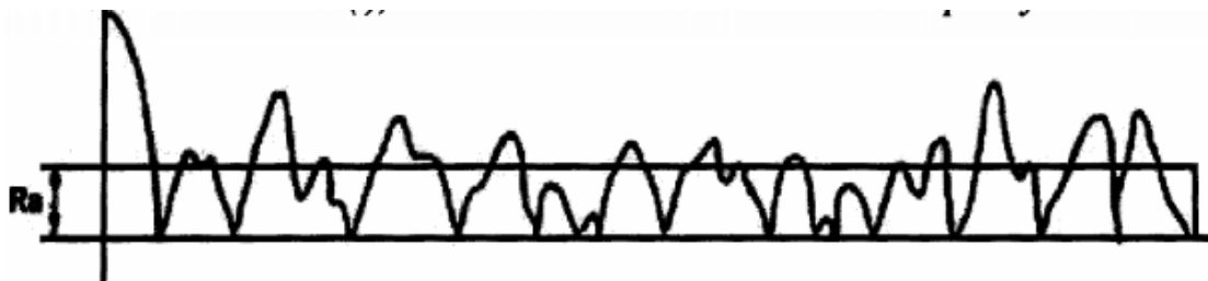
Figura 2. Traslación inversa de los valles del perfil por encima de la línea media
