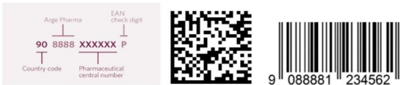
Figura 7. Diferentes estructuras de códigos de cifrado convencionales. Fuente: (Rösler, 2020).
