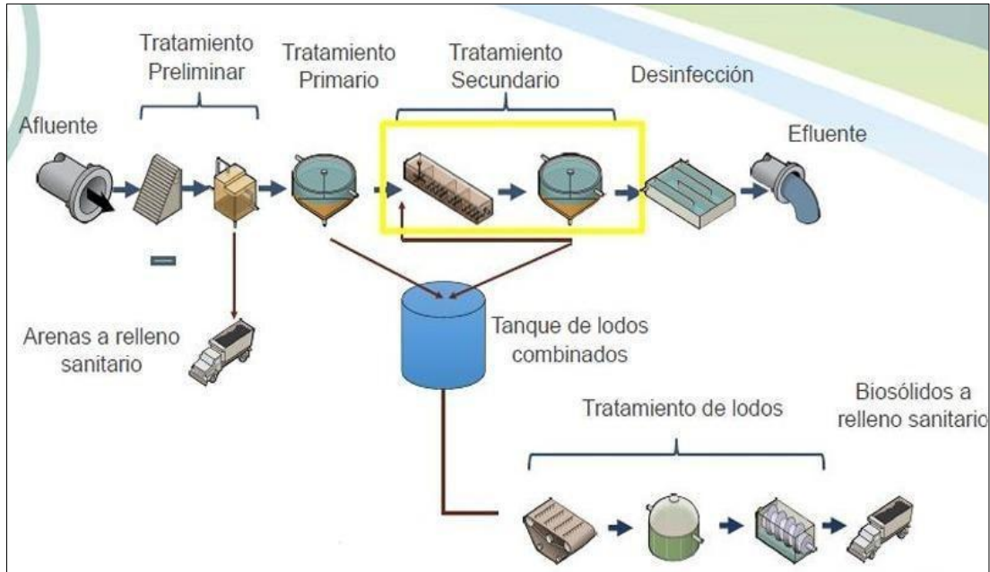
Figura 1. Esquema general del tratamiento de aguas residuales urbanas. Fuente: Aguas y Aguas de Pereira S.A. E.S.P. (2019). Capítulo 2. Descripción del proyecto: Planta de Tratamiento de Aguas Residuales (PTAR) El Paraíso, municipios de Pereira y Dosquebradas. En Estudio de Impacto Ambiental del Proyecto PTAR El Paraíso. Pereira, Colombia: Aguas y Aguas de Pereira S.A. E.S.P., en asociación con Hazen, Fichtner y Conhydra S.A.
