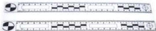
Fig.3 Testigo tipo regleta importantes al momento de toma de fotografía o video
