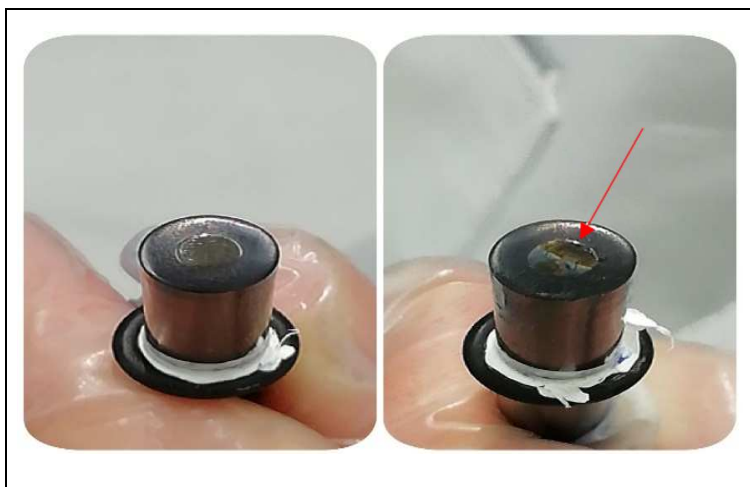
Imagen 3: Electrodo de trabajo (pulido) carbón vítreo imagen de la izquierda antes de empezar a correr los ciclos. La imagen de la derecha evidencia la barrera una vez se han corrido 30 ciclos de compuesto 1a) velocidad de barrido 100 mV/s
