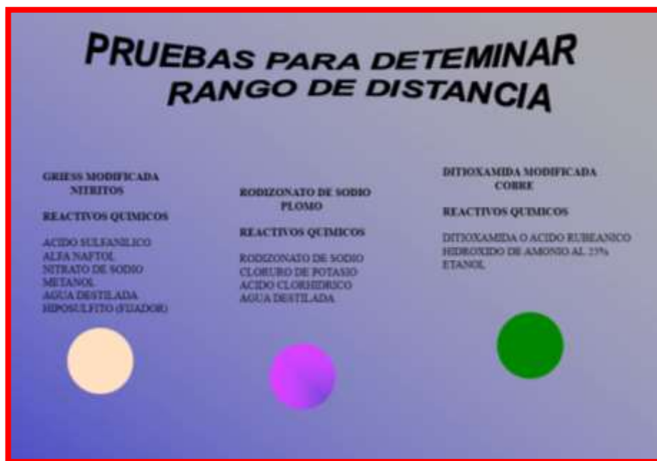
Figura 18: Composición y resultado de pruebas de determinación del rango de distancia
