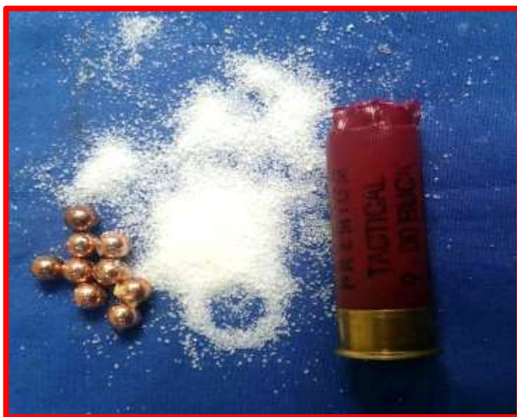
Figura 11: Relleno de polietileno empleado en cartuchos de carga múltiple
