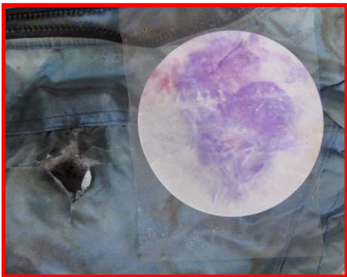
Figura 19: Ejemplo de resultado con prueba de rodizonato de sodio para plomo
