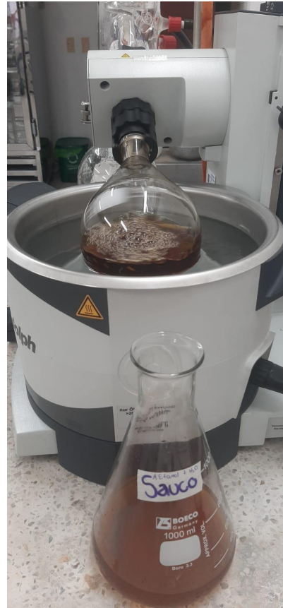
Figura 9. Concentración de extracto en Rotaevaporador.
