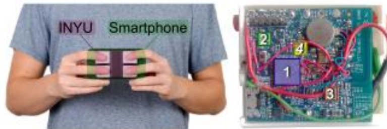
Fig. 3. Sensor INYU. Delanero: 1: STM32L151RDT6 (ARM Cortex-M3 MCU, 384 KB Flash, 48 KB RAM), 2: MPU-6000 (6 ejes I sensor Cmotion), 3: nRF8001 (Bluetooth baja energía v4.0 radio). Atrás: 4: ADS1191 (interfaz analoga para aplicaciones de ECG).
