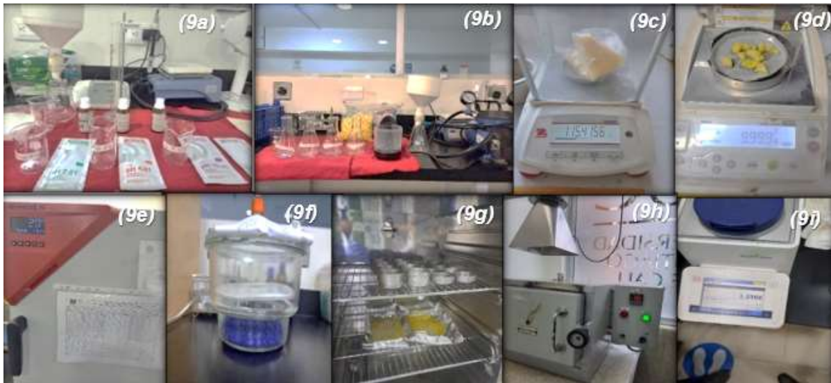
Imagen 9. Equipos de laboratorio utilizados en los análisis fisicoquímicos, 9a). pH-metro, conductímetro, y soluciones buffer para calibración de equipos, 9b). Equipo de filtración al vacío, 9c). Balanza analítica, 9d). Balanza para análisis de humedad y sólidos (Propal), 9e). Horno eléctrico, 9f). Desecador, 9g) parte interna Horno, cápsulas y silica gel, 9h) Mufla, 9i) Refractómetro.
