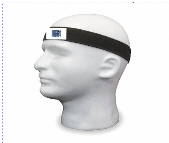
Figura 6. Diseño de banda con acelerómetro Fuente. Elaboración propia.
