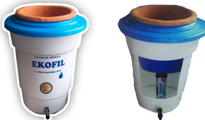
Figura 1. Modelo de filtros de la empresa Replacol. A. Diseño exterior del filtro con vasija de arcilla porosa y baño de plata coloidal. B. Diseño interior del filtro con columna de carbón activado (EKOFIL PLUS).
